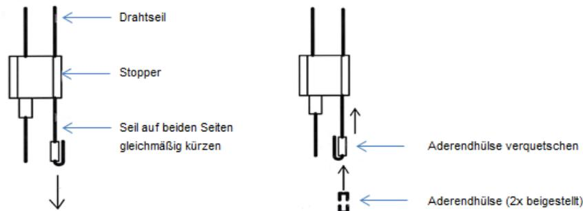
Das Drahtseil nach unten aus dem Stopper ziehen und auf beiden Seiten auf die gewünschte Länge kürzen
